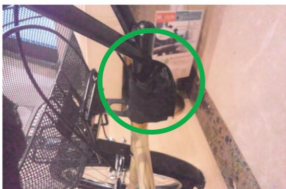
図2 レンタサイクルへのGPS設置
