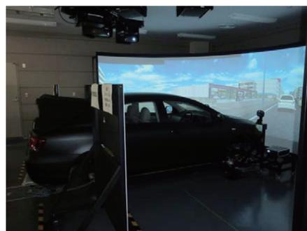
図1：実験で利用したドライビングシミュレータ
