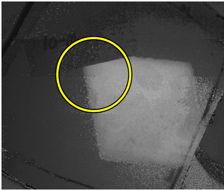
図 11 面光源の投影（照射部の境界付近の黄色の枠の中心に塗装欠陥が観察される）
