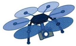
UAVの一種マルチコプター(複数のローター有するヘリ)にデジタルカメラを搭載し、空中から写真やビデオを撮影します。
